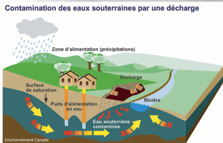
Figure 3.1.13 : Exemple de contamination des eaux souterraines par une source ponctuelle de pollution. (Source : Environnement Canada)
